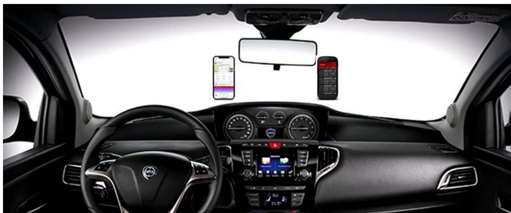
Fig. 22 Posizionamento dei dispositivi sul parabrezza.
