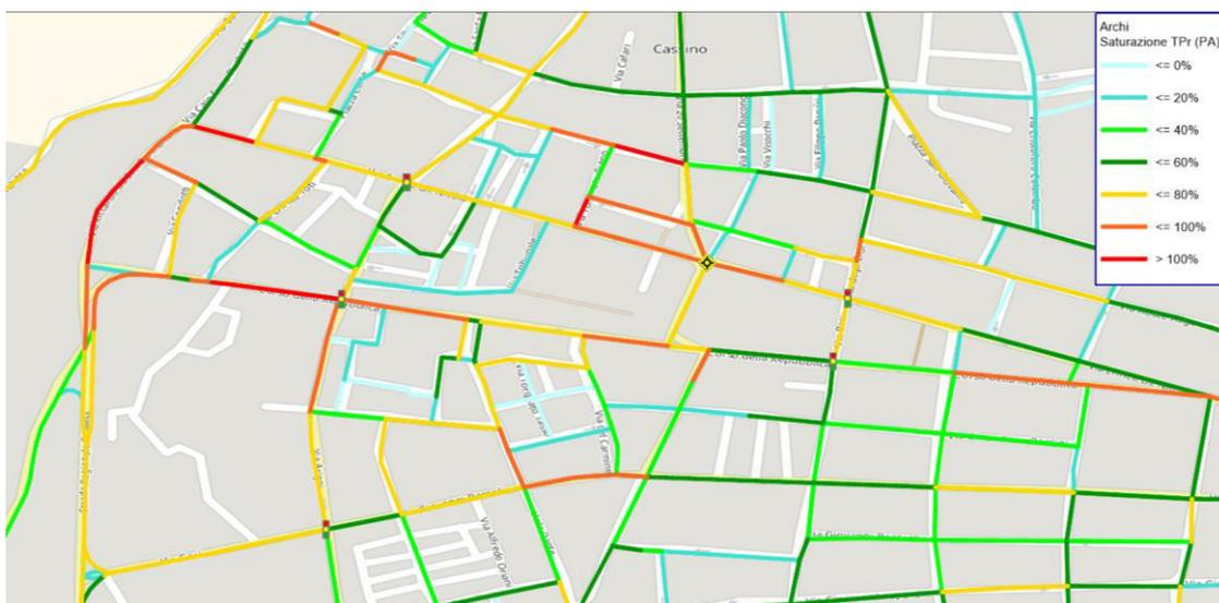
**Fig. 51.** Risultato grafico dell'assegnazione per la fascia oraria pomeridiana di punta mediante la rappresentazione del rapporto di saturazione (17:30-18:30).
